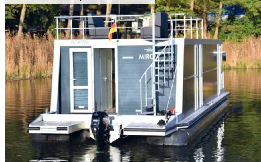
Heckansicht mit zwei Badestegen und dem 44,1 kW (60 PS) leistenden Mercury-F60-Motor
